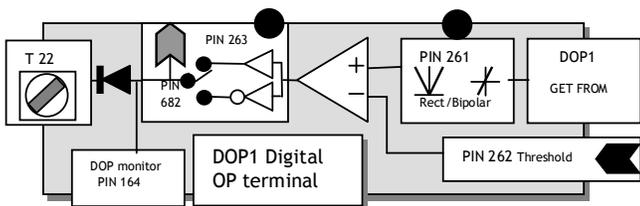
13.8.1.1 DOPX SETUP / DOP1/2/3 OP val rectify enable PINs 261 / 264 / 267
