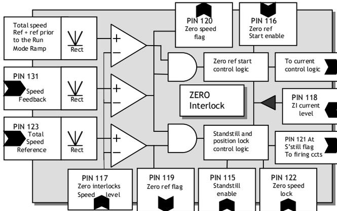
6.10.2 ZERO INTERLOCKS / Standstill enable PIN 115
