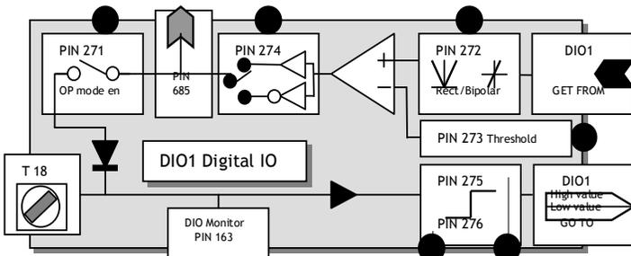
13.7.1.1 DIOX SETUP / DIO1/2/3/4 Output mode enable PINs 271 / 277 / 283 / 289
